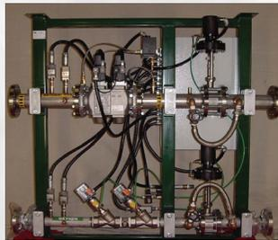
Tren de tuberías de seguridad y control de caudal de Oxígeno y Gas Natural
