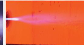
Temperatura del horno: 900 °C con un 3 % de O<sub>2</sub> primario.
