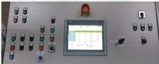
**Control de quemadores:** Sistemas compactos de regulación de quemadores individuales o múltiples con componentes de alta calidad, totalmente compatibles con las normas EN 746-2, NFPA86 e ISO13577, cumpliendo con el nivel SIL requerido y son compatibles con CE. Todos los sistemas se fabrican en Austria, Alemania y Suiza.
