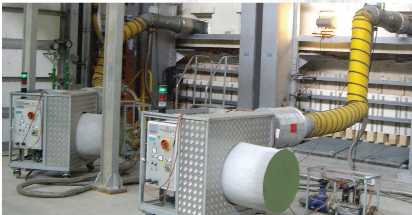
Desde 1963 Hotwork ha proporcionado el calentamiento de los hornos a los principales fabricantes de vidrio en todo el mundo. Nuestra tecnología especial de calentamiento está basada en el uso de calentadores de alta velocidad operados sobre una base de aire en exceso, desarrollados especialmente para el calentamiento de cualquier tipo y tamaño de horno de vidrio. Este sistema permite una presión favorable en el horno, asegurando temperaturas uniformes dentro del mismo y en los regeneradores.
