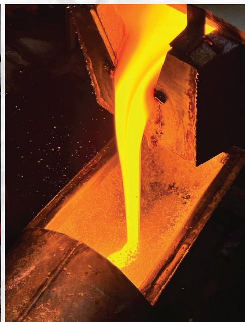
**Drenaje de horno con reciclaje completo de agua 600 T de vidrio drenadas en 32 horas usando un raspador y una torre.**
